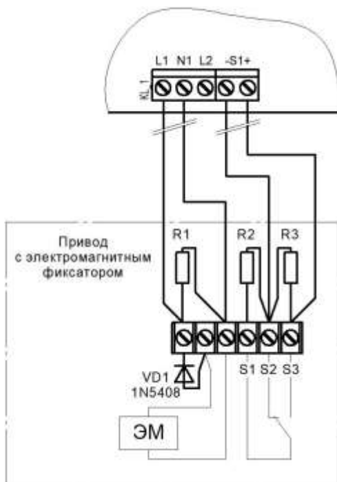
Рисунок 156 – Схема подключения привода с электромагнитным фиксатором без встроенного диода
